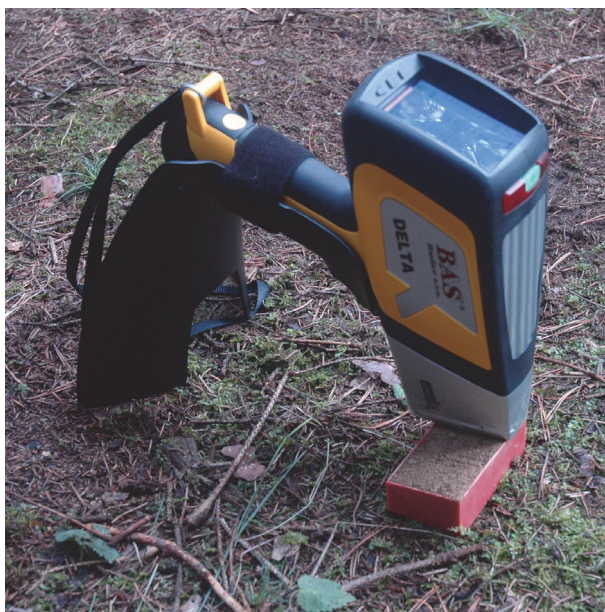
Měření prvkového složení půd v terénu pomocí rentgenového fluorescenčního spektrometru (foto: Karel Němeček)
