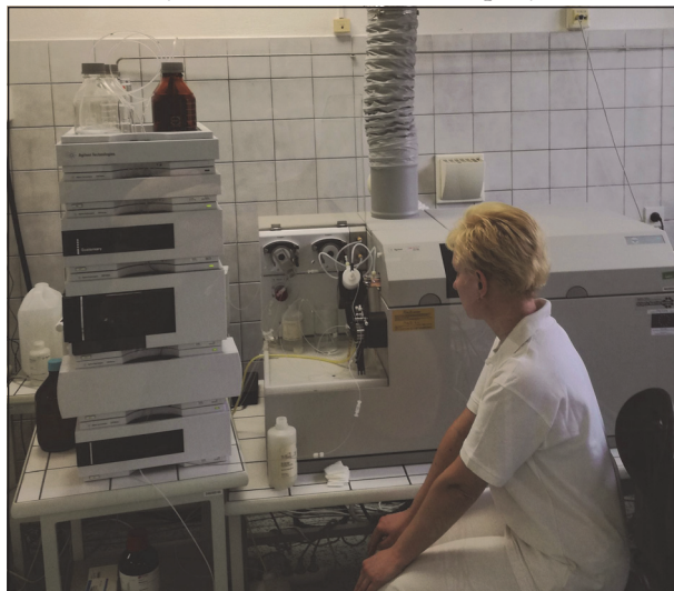
Měření na optickém emisním spektrometru s hmotnostním detektorem (ICP-MS) v laboroři ÚKZÚZ
