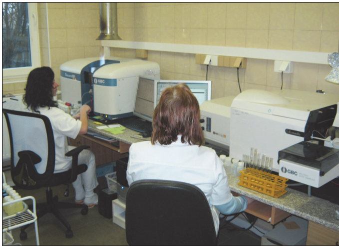
Atomová absorpční spektrofotometrie s plamenovou technikou a s grafitovou kytetou umožní stanovení celé šíře těžkých kovů
