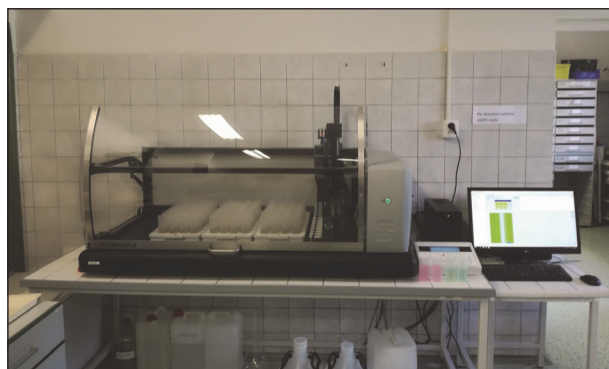
Automatizace měření pH – robotický analyzátor SKALAR, laboroř ÚKZÚZ Brno
