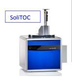
ANALIZATOR DO JEDNOCZESNEGO OZNACZANIA WSZYSTKICH FRAKCJI WĘGLA ORGANICZNEGO (BIODEGRADOWALNEGO AOC I RESZTKOWEGO ROC) ORAZ NIEORGANICZNEGO TIC I CAŁKOWITEGO TC, Z OPCJĄ DO AZOTU CAŁKOWITEGO TN W PRÓBKACH STAŁYCH METODĄ GRADIENTÓW TEMPERATUROWYCH.
