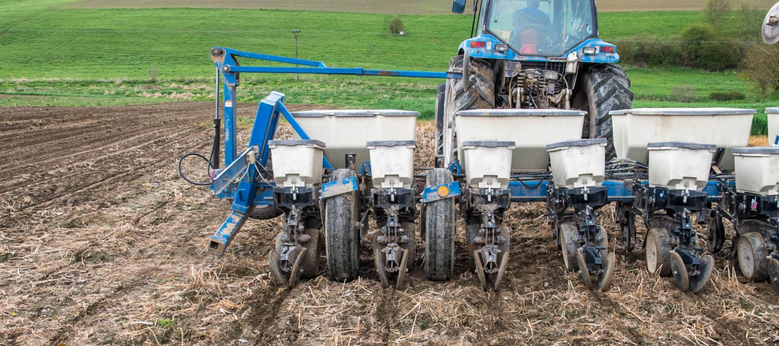
Obrázek 6. Výsev kukuřice bezorebným secím strojem do vymrzající meziploidy
