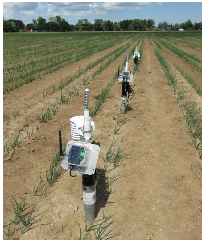
Obrázek 2. Dataloggery s online přenosem dat z čidel na měření půdní vlhkosti a půdního vodního potenciálu
