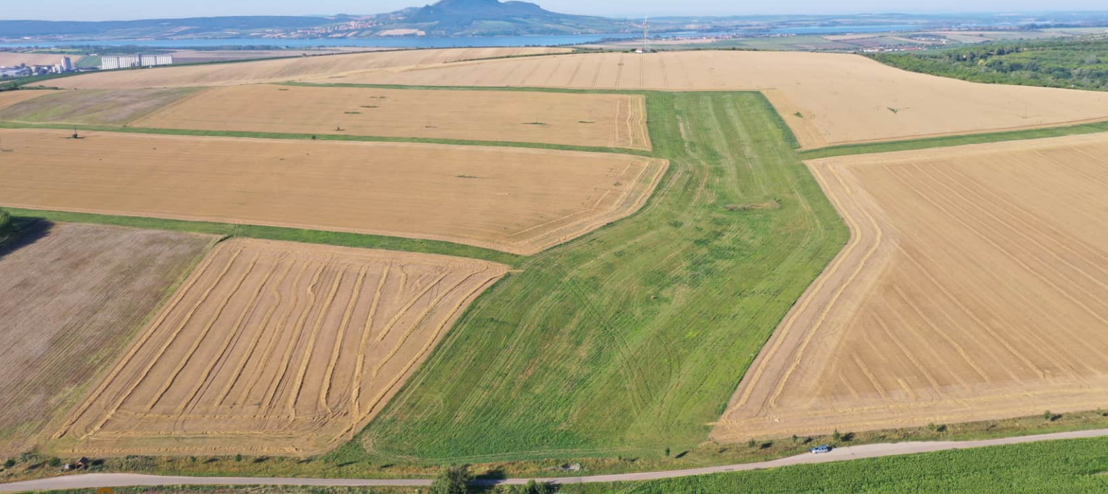
Obrázek 4. Stabilizovaná dráha soustředěného odtoku a protierozní travní pásy v k.ú. Starovice
