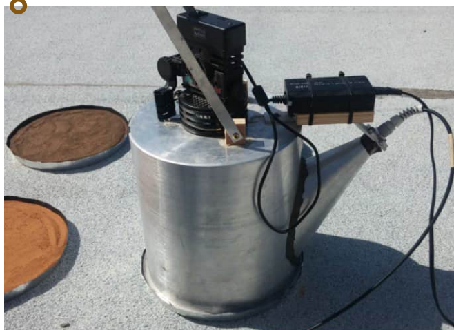
Obrázek 5. Zařízení SoilPro® pro měření půdních spekter v polních podmínkách.
