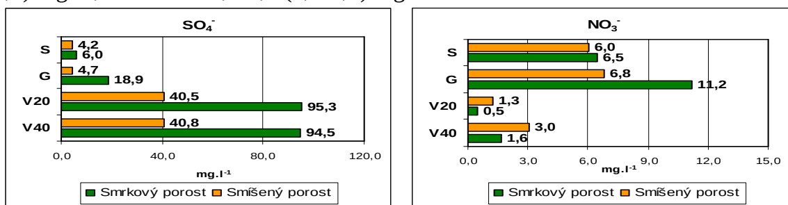
Obr. 5, 6 SO_4^{2-} , NO_3^- - roční průměrné hodnoty (S - srážkoměr, G - gravitační lyzimetr, V 20, V40 - vakuový lyzimetr v hloubce 20 a 40 cm po povrchu)
