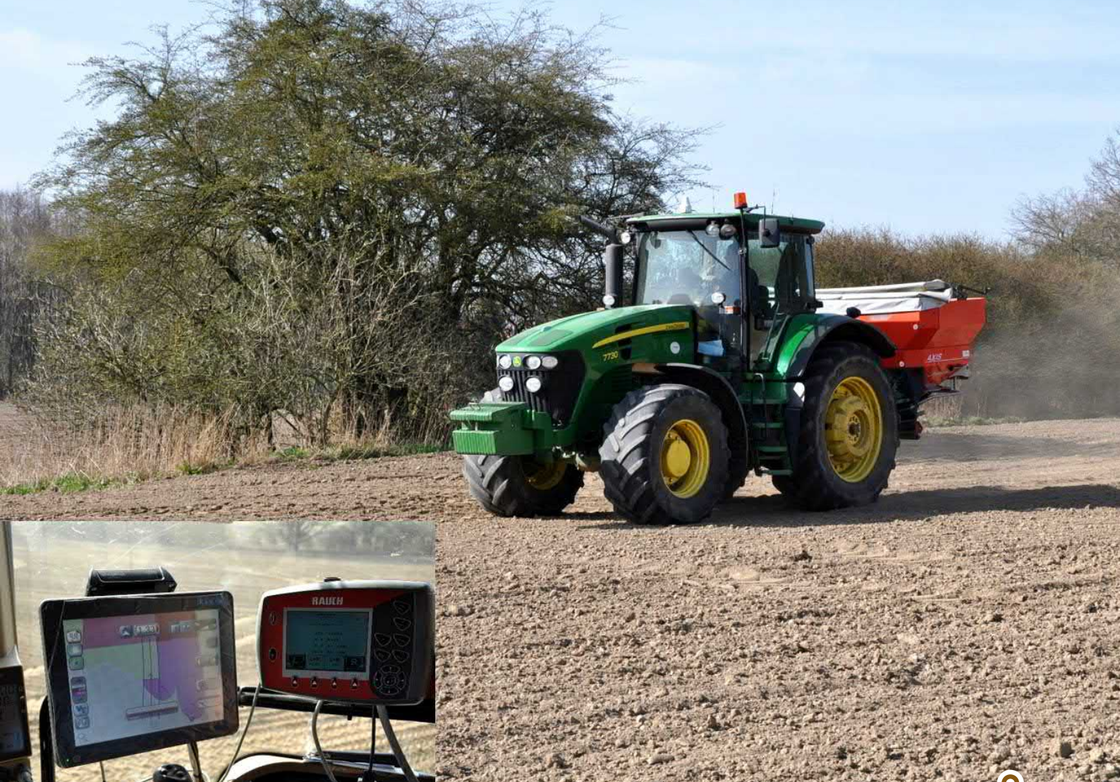
Obrázek 4. Precizní aplikace dusíkatého hnojiva podle aplikační mapy [Foto P. Fučík]
