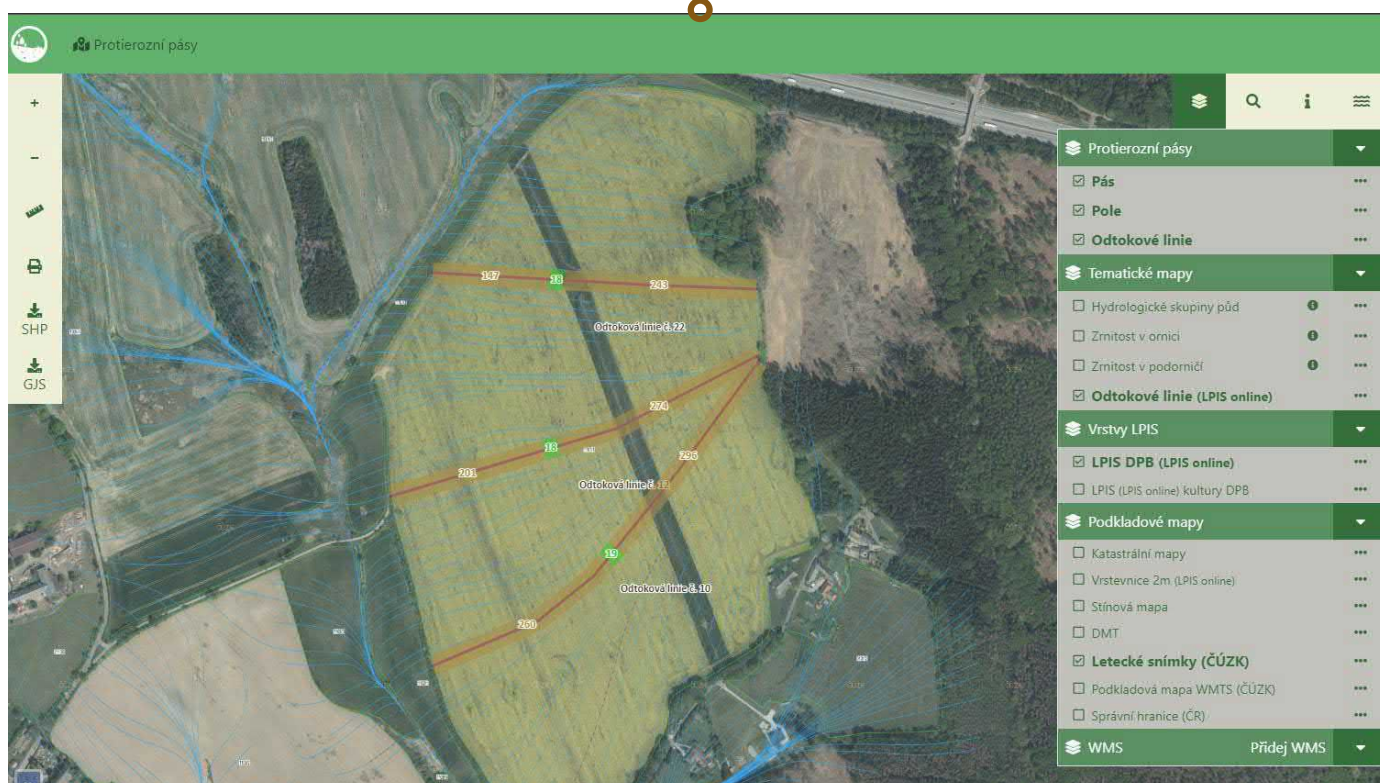
Obrázek 4. Ukázka výpočtu umístění polohy a šířky protierozního travního pásu na 3 uživatelem definovaných odtokových liniích na modelovém svahu
