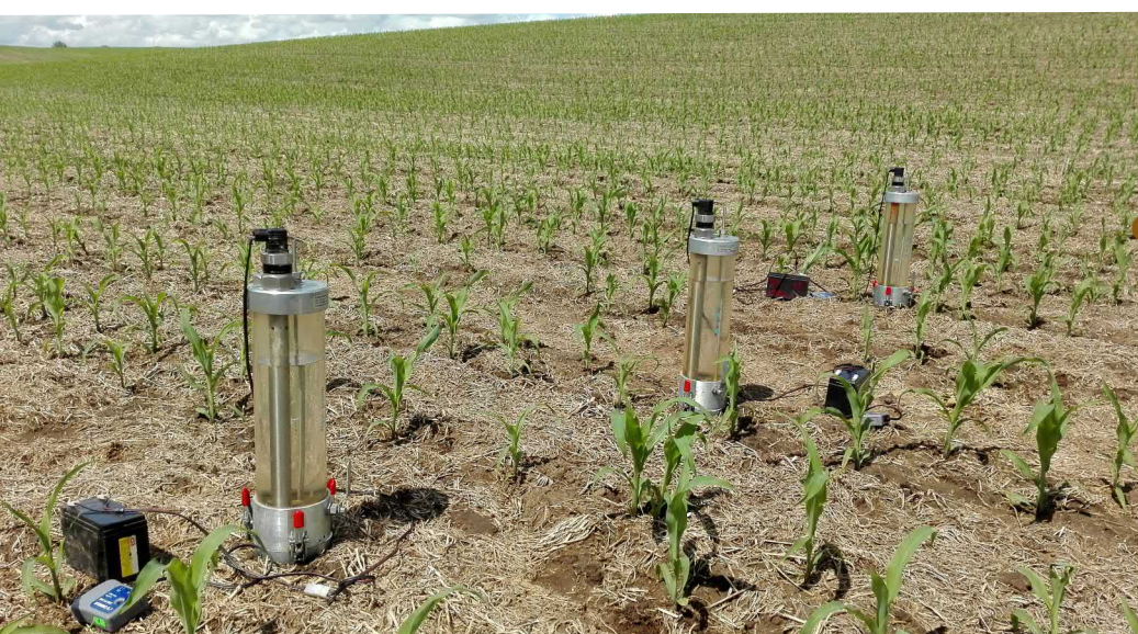
Obrázek 11. Vybavení měřicího profilu (přeliv, UZV sonda, srážkoměr, datalogger, vzorkovač vody - vlevo v opevnění běhu)
