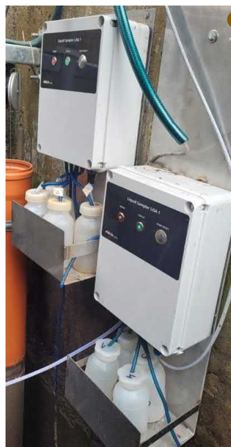
Obrázek 2. Instalace dálkově řízeného regulačního prvku a vzorkovače vody LISA v šachtici tradiční stavby odvodnění na lokalitě Louka Pokřikov. Vybavení experimentálního objektu systémy pro monitoring drenážního odtoku (konduktivita, teplota, průtok, úroveň regulované hladiny).
