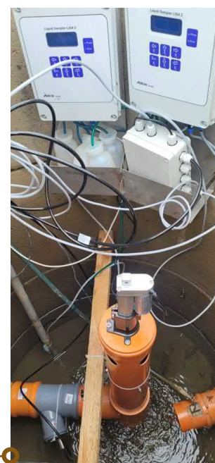
Obrázek 2. Instalace dálkově řízeného regulačního prvku a vzorkovače vody LISA v šachtici tradiční stavby odvodnění na lokalitě Louka Pokřikov. Vybavení experimentálního objektu systémy pro monitoring drenážního odtoku (konduktivita, teplota, průtok, úroveň regulované hladiny).
